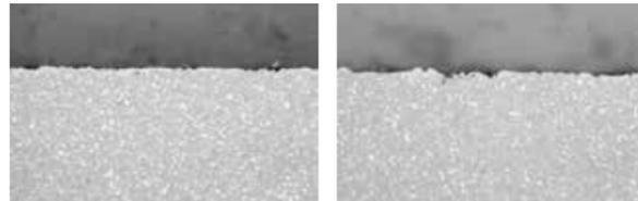
Unbeschädigte Oberfläche, die mit IonoFil erodiert wurde.
